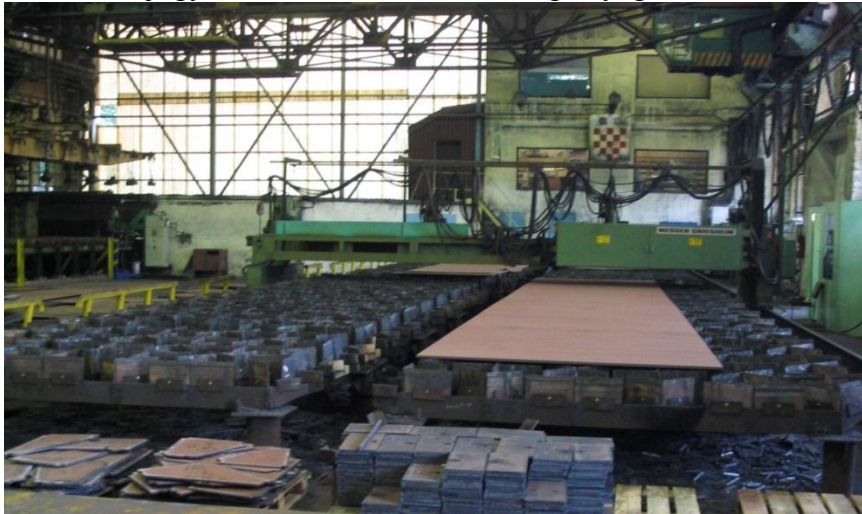
2.12. ábra: NC lángvágó asztal a Május 3 hajógyárban (Rijeka, Horvátország)
