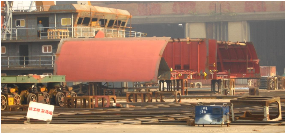
3.8. ábra: Térszekció építése alkatrészekből a Jinling hajógyárban (Nanjing, Kína)
