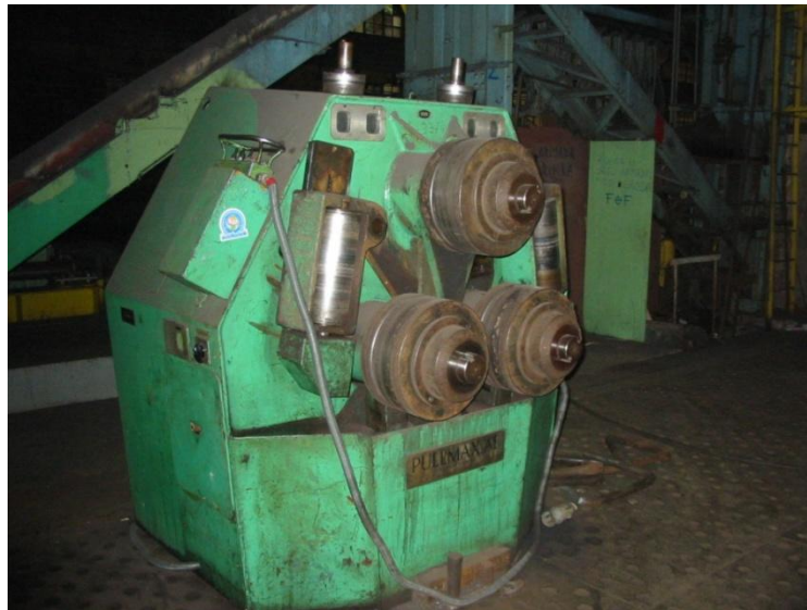
2.27. ábra: Profilhajlító gép a Május 3 hajógyárban (Rijeka, Horvátország)
