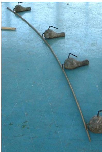
1.6. ábra: Vonalterv rajzolósa delfinokkal leszorított svungléccel
