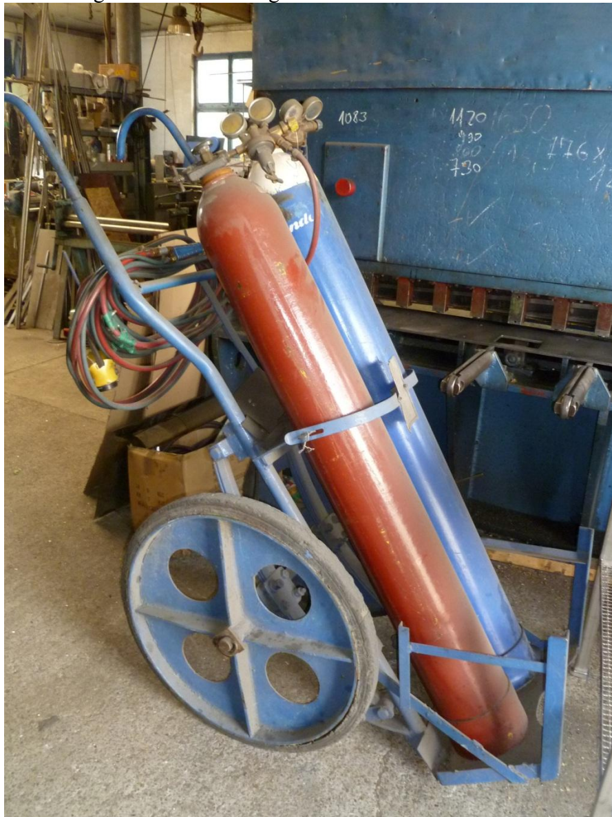
2.30. ábra: Gázhegesztő készülék a Furtinox Kft.-nél (Budapest)
