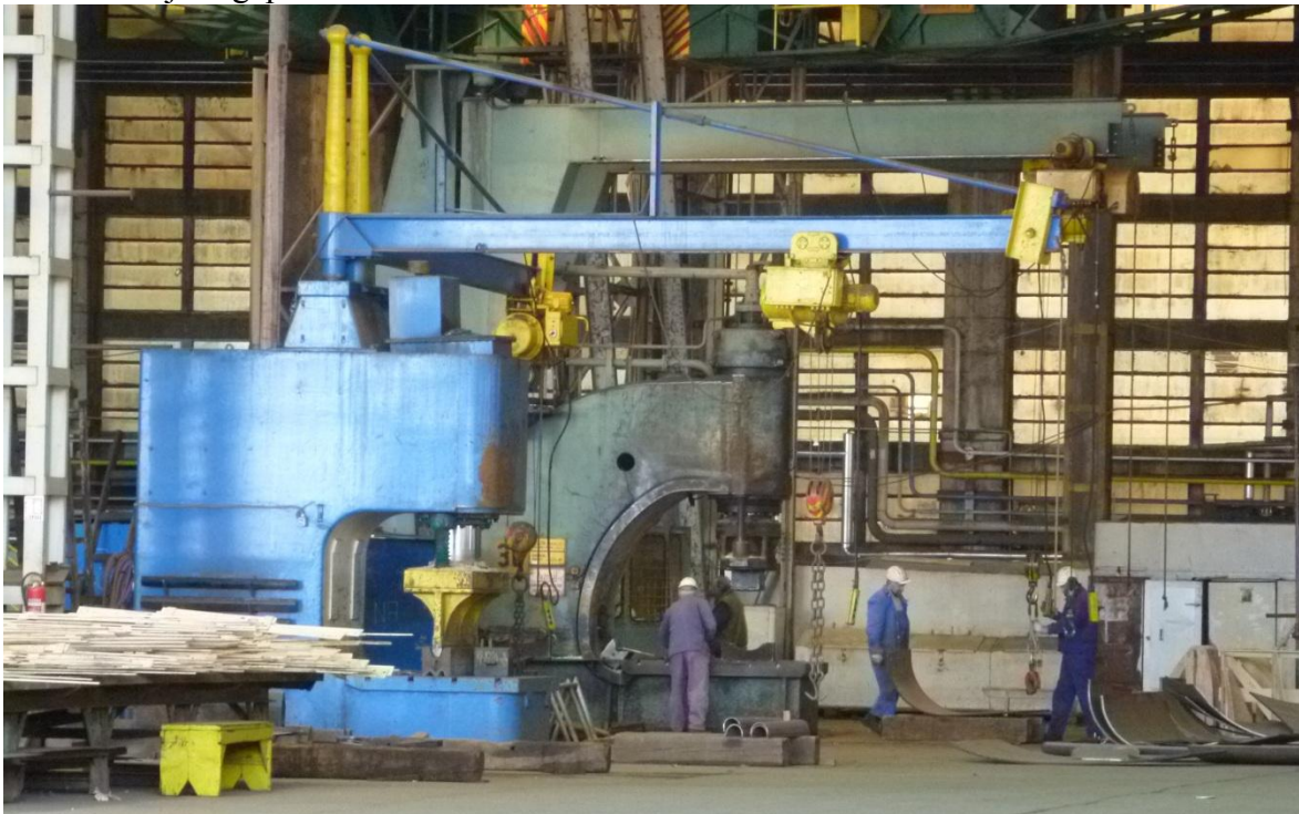
2.21. ábra: Domborító és hajlító sajtók az Uljanik hajógyárban (Pula, Horvátország)
