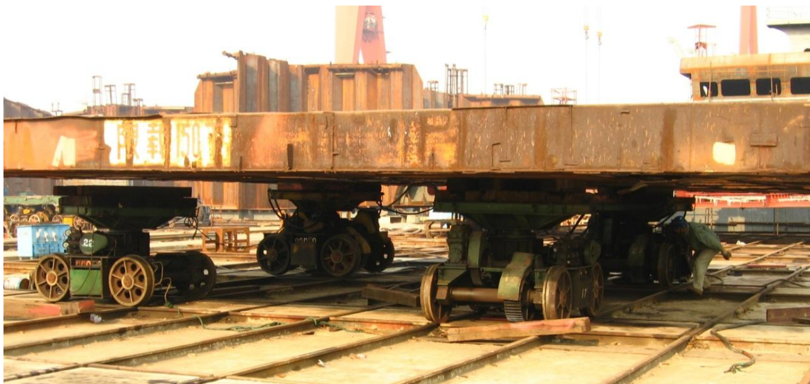
3.12. ábra: 150t teherbírású hajómozgató kocsik a hajó sólyatérre történő szállításhoz
