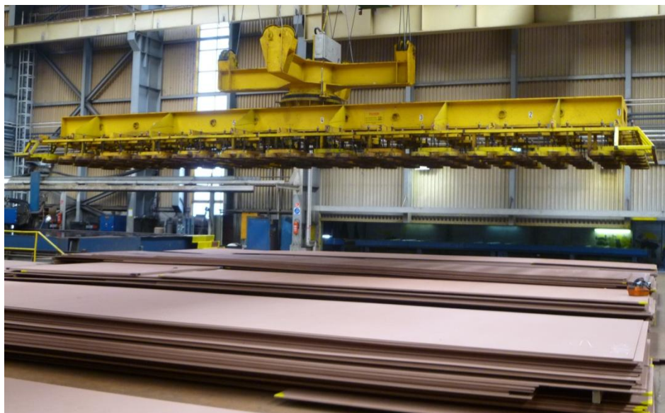
1.12. ábra: Lemeztáblák lángvágás előtt, az ütemtárolóban. (Uljanik hajógyár, Pula, Horvátország)
