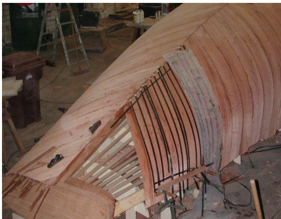
6.24. ábra: A csikok rögzítése kapcsokkal
