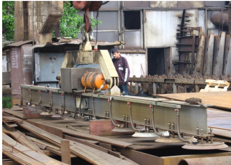
1.13. ábra: Mágneses lemezemelő gerenda a Severnav hajógyárban (Szörénytornya, Románia)
