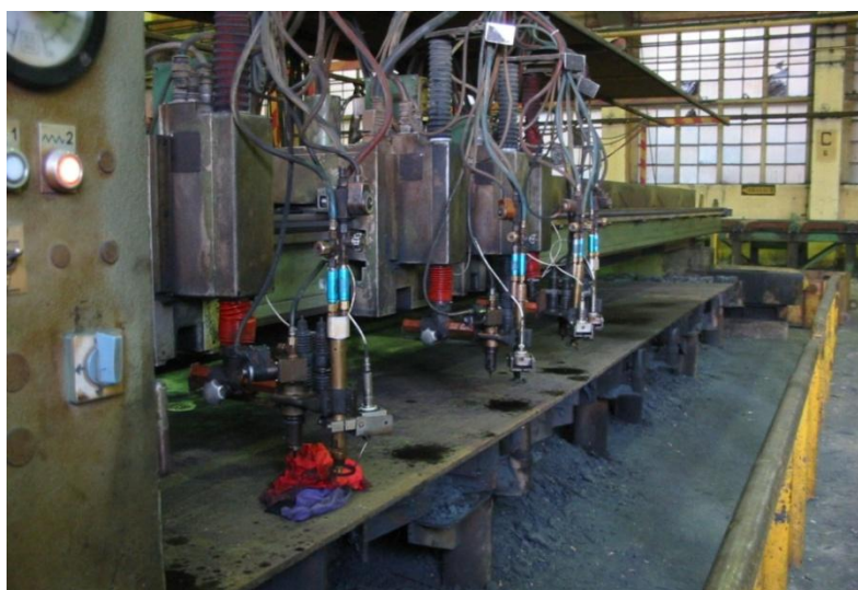
2.11. ábra: Többfejes lángvágó gép a Május 3 hajógyárban (Rijeka, Horvátország)
