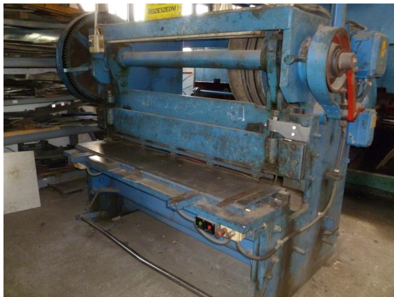
2.9. ábra: Ferdeéles lemezolló a Furtinox Kft.-nél (Budapest)
