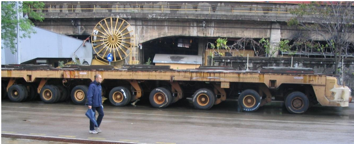
3.13. ábra: Szekciómozgató kocsi a Május 3 hajógyárban (Rijeka, Horvátország)
