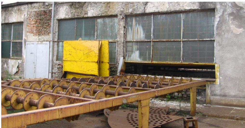
1.14. ábra: Görgősor a lemeztáblák mozgatásához a Severnav hajógyárban
