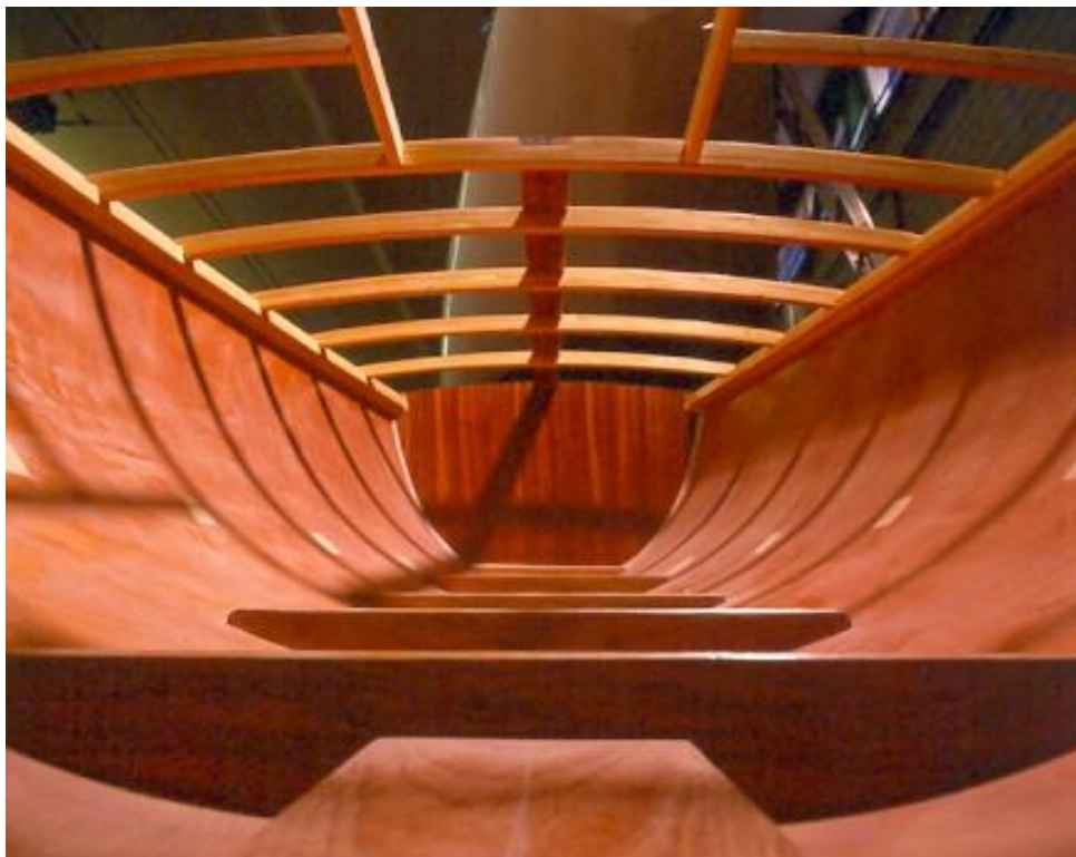
6.28. ábra: A héj belülről (látszik, hogy nincs benne felületi merevítés)
