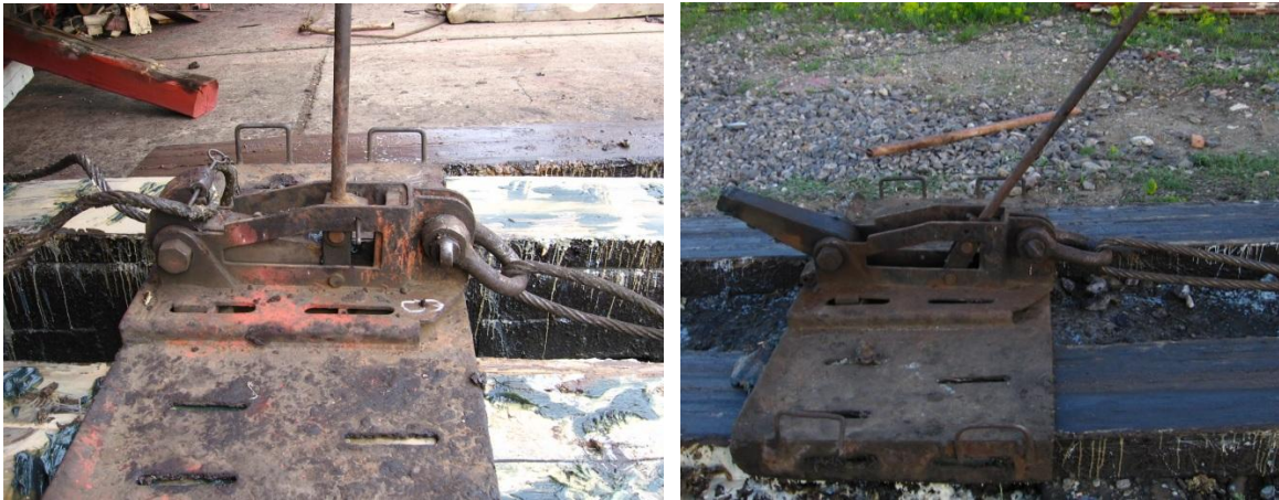
4.1. ábra: Sólyaszánkó kioldó szerkezet bekötött és nyitott állapotban a Severnav hajógyárban
