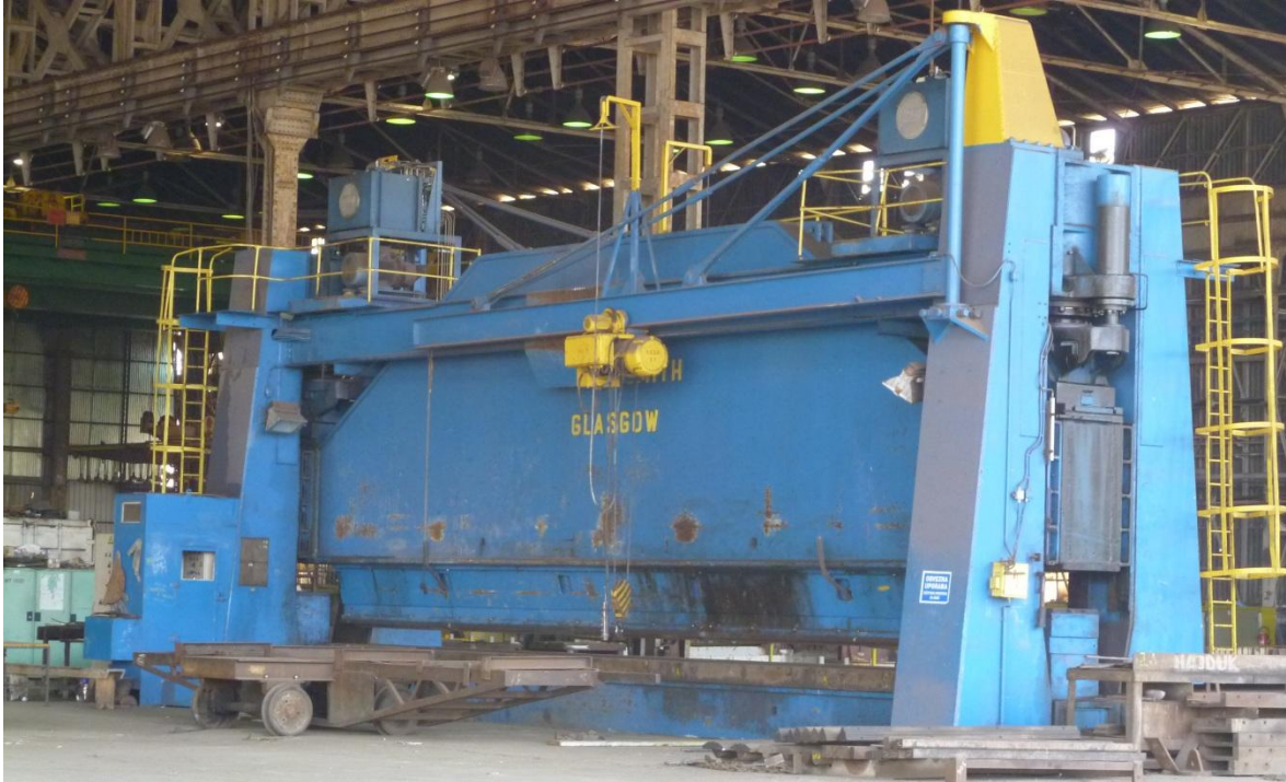
2.17. ábra: Prizmás élhajlító gép az Uljanik hajógyárban (Pula, Horvátország)
