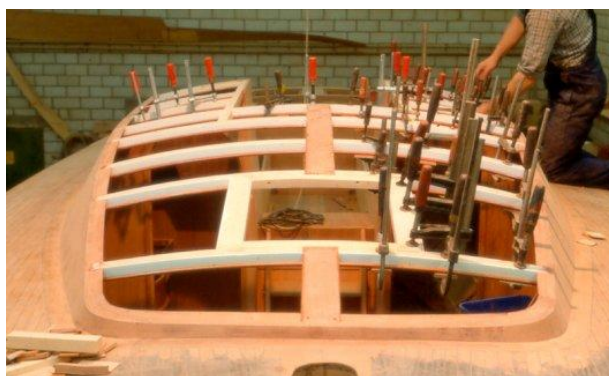
6.41. ábra: A kajüttető bordáinak beépítése
