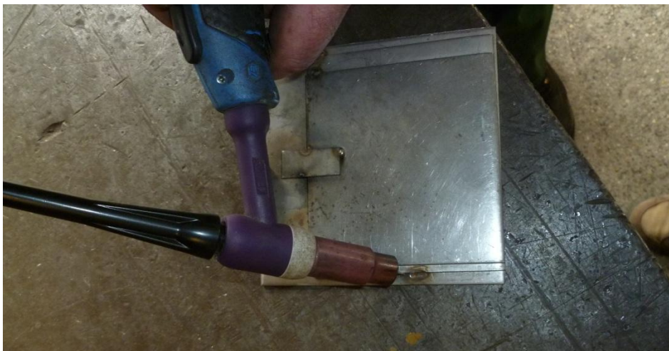
2.37. ábra: Argon védőgázos, wolfram elektródás kézi ívhegesztő a Furtinox Kft.-nél (Budapest)
