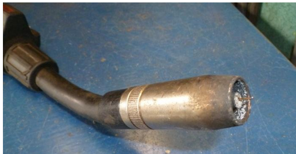
2.38. ábra: CO 2 védőgázos, fogyó elektródás ívhegesztő pisztoly a Furtinox Kft.-nél (Budapest)
