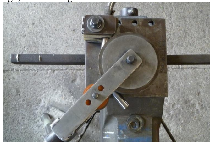
2.28. ábra: Görgős csőhajlító a Furtinox Kft.-nél (Budapest)
