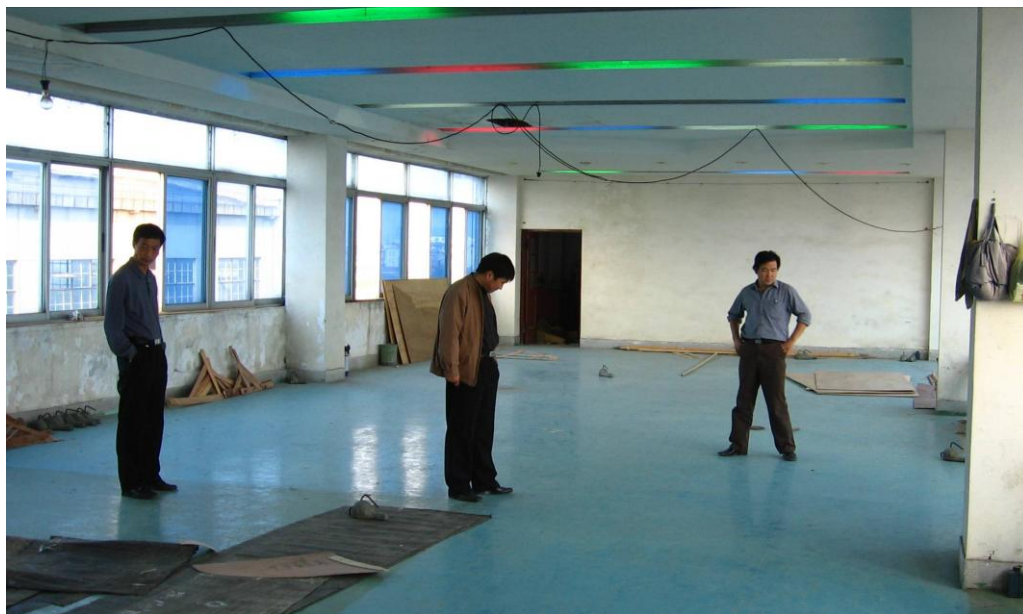
1.5. ábra: Rajzpadlás a Dajiang hajógyárban (Wuhu, Kína)
