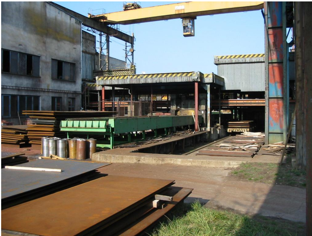
2.2. ábra: Lemezegyengető gépsor az SLKB hajógyárban (Révkomárom, Szlovákia)
