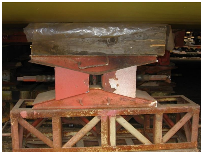
4.4. ábra: Menetes alátámasztó elem a sólyaszék tetején a Severnav hajógyárban
