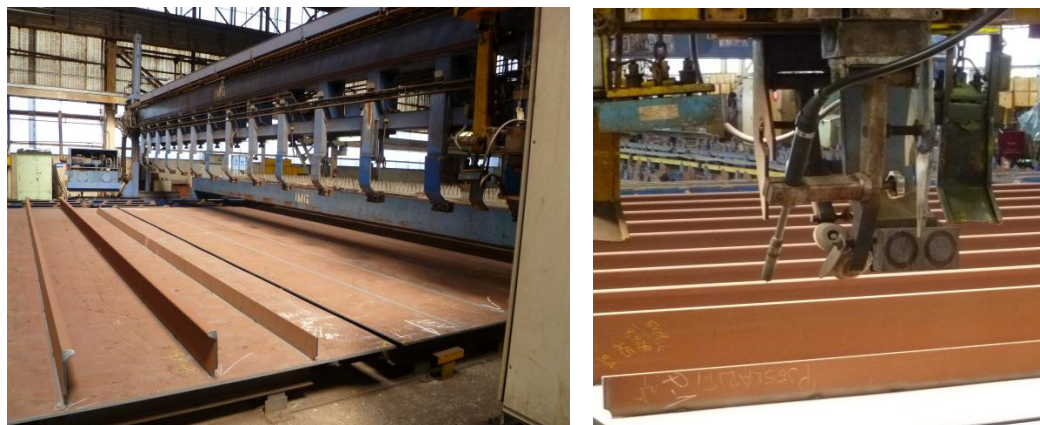
3.6. ábra: Bordahegesztő gép az Uljanik hajógyárban (Pula, Horvátország)
