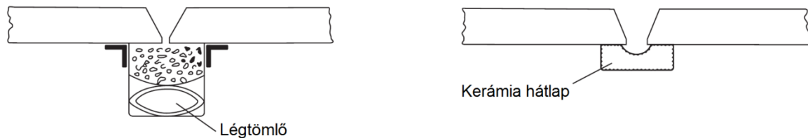
2.36. ábra: Gyökvarrat képzési módszerek egyoldali hegesztésnél
