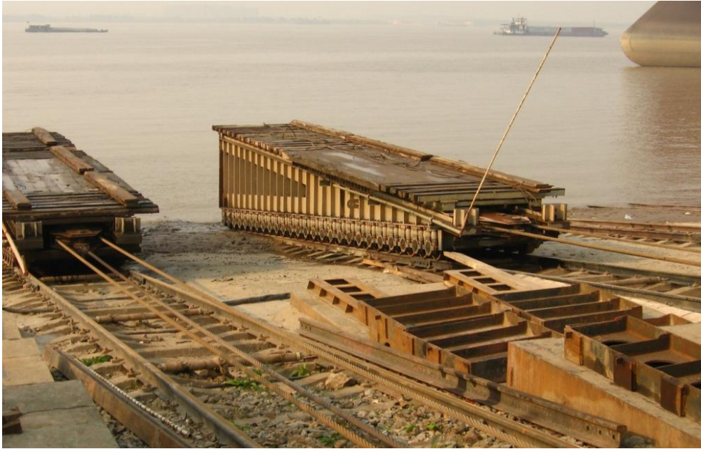
4.9. ábra: 600t teherbírásúsúlyakocsik a Jinling hajógyárban (Nanjing, Kína)
