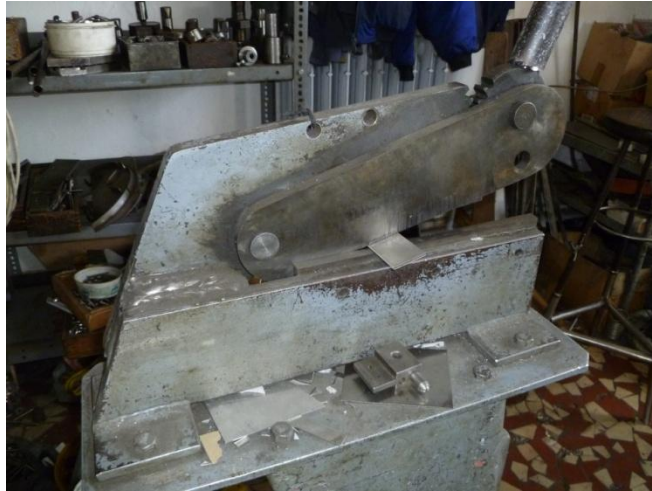
2.8. ábra: Karos lemezolló a Furtinox Kft.-nél (Budapest)
