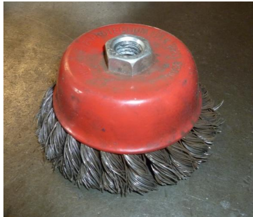
2.4. ábra: Kúp alakú gépi drótkéfe
