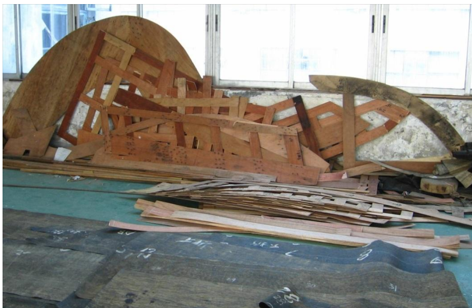
1.7. ábra: A rajzpadlás által készített sablonok és szabástervek
