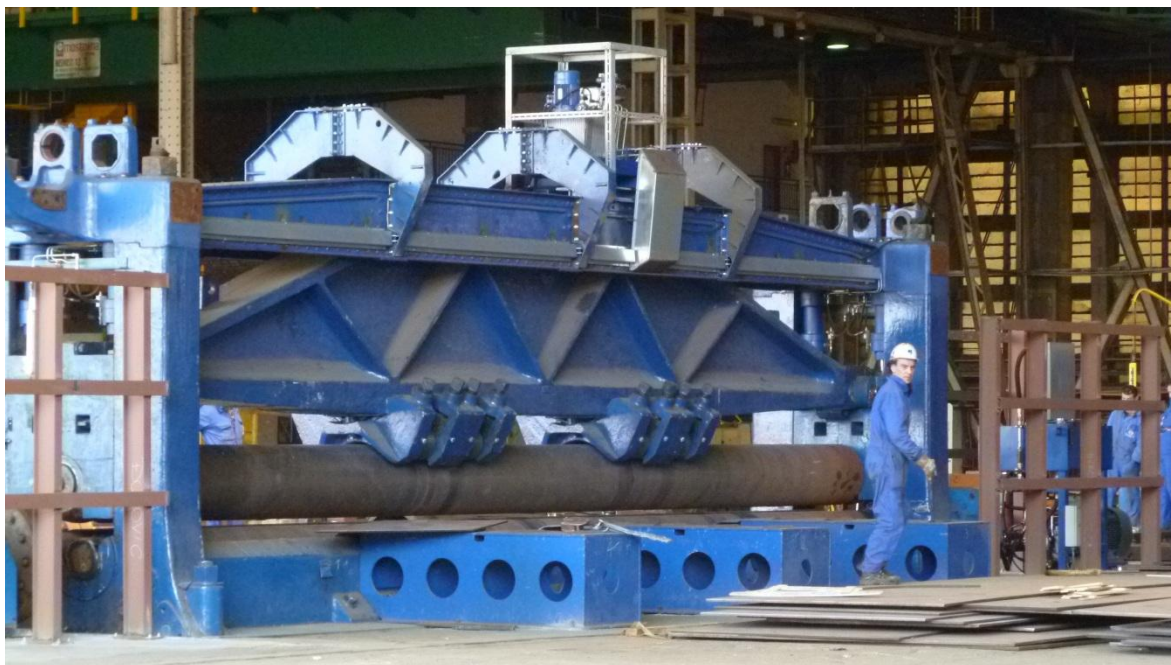
2.19. ábra: Lemezhajlító hengerlőgép az Uljanik hajógyárban (Pula, Horvátország)
