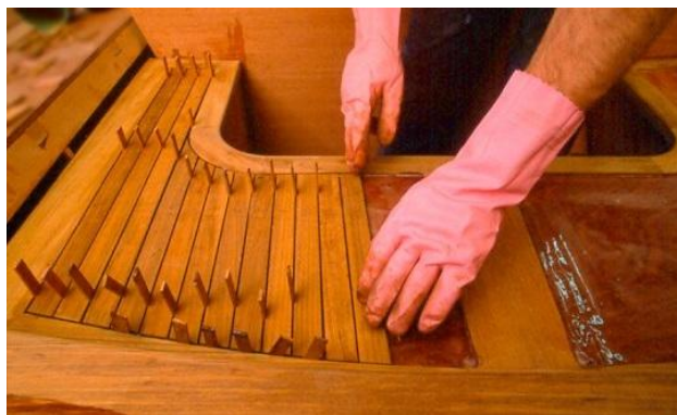
6.39. ábra: Teakfa lécezés készítése rétegelt lemez alapra
