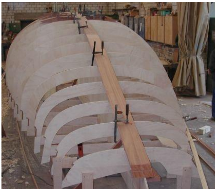
6.21. ábra: A gerinc elhelyezése a bordavázon
