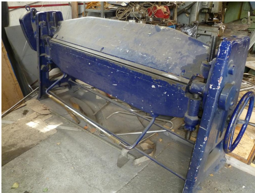
2.16. ábra: Lengőasztalos élhajlító a Furtinox Kft.-nél (Budapest)
