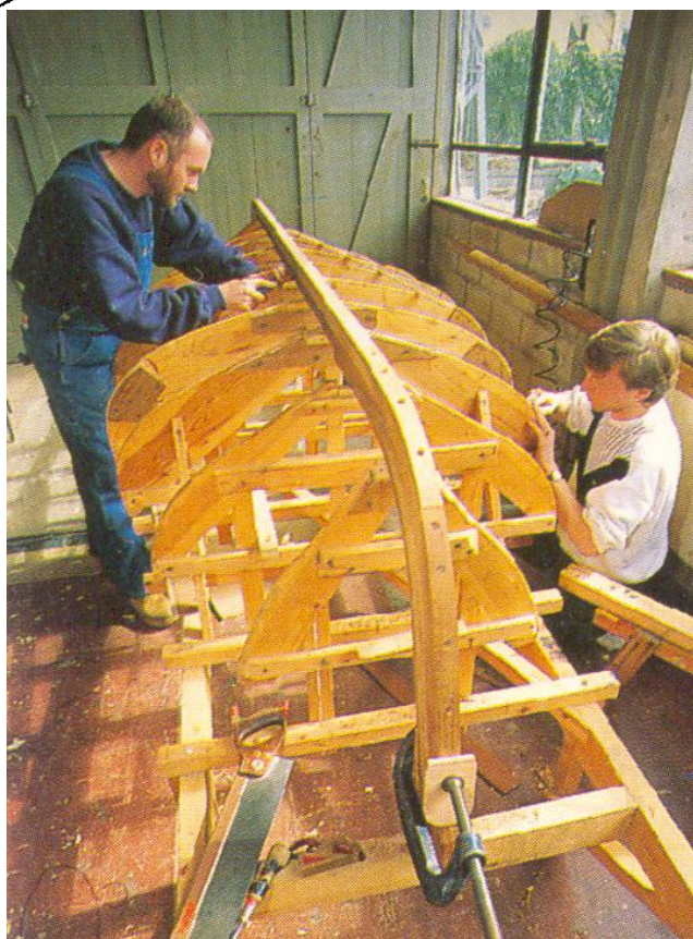
6.5. ábra: Építő iker-gerenda fordított építési módnál
