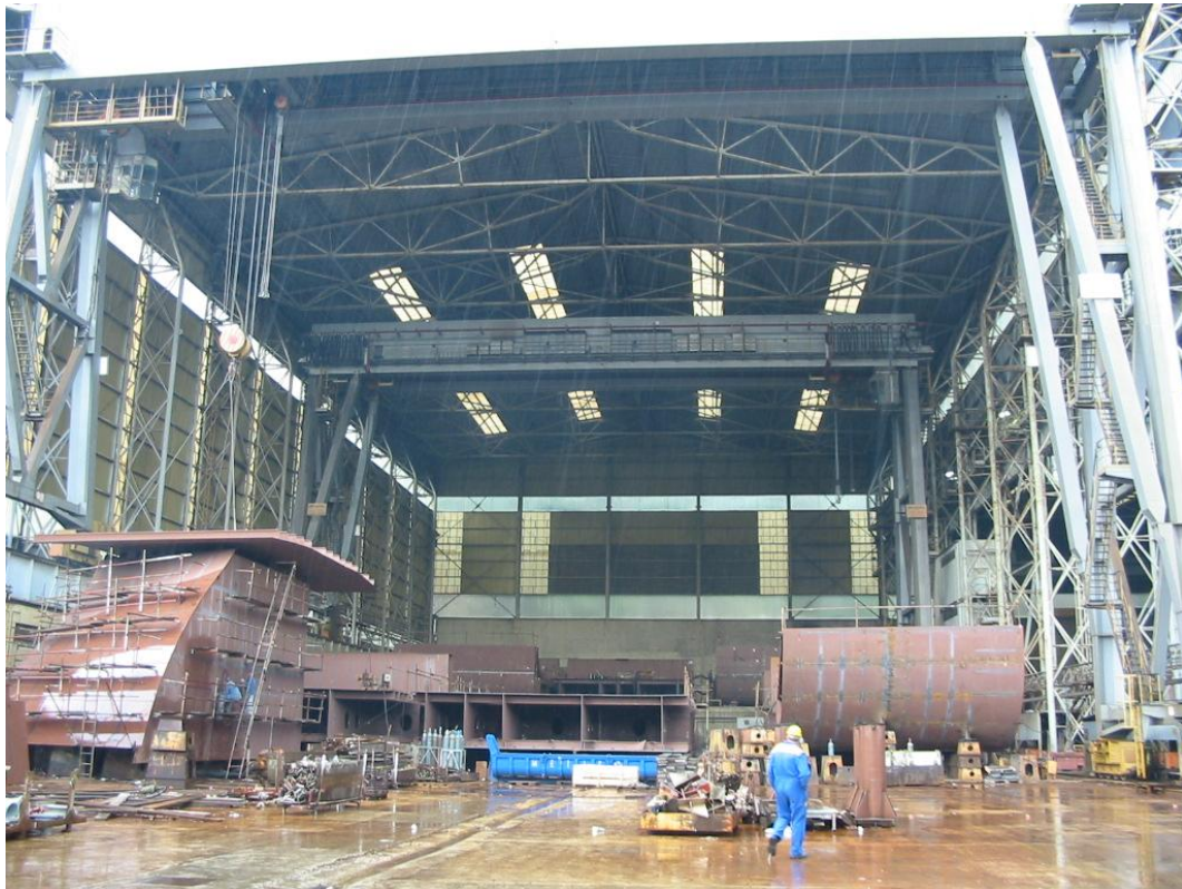
3.7. ábra: Térszekció-gyártás félig fedett műhelyben a Május 3 hajógyárban (Rijeka, Horvátország)
