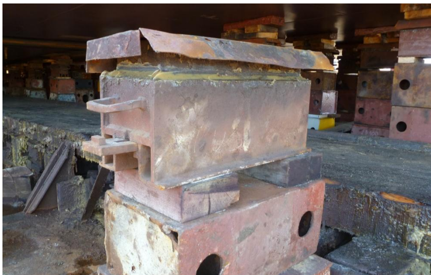
4.3. ábra: Homoktöltéses alátámasztó elem a sólyaszék tetején az Uljanik hajógyárban
