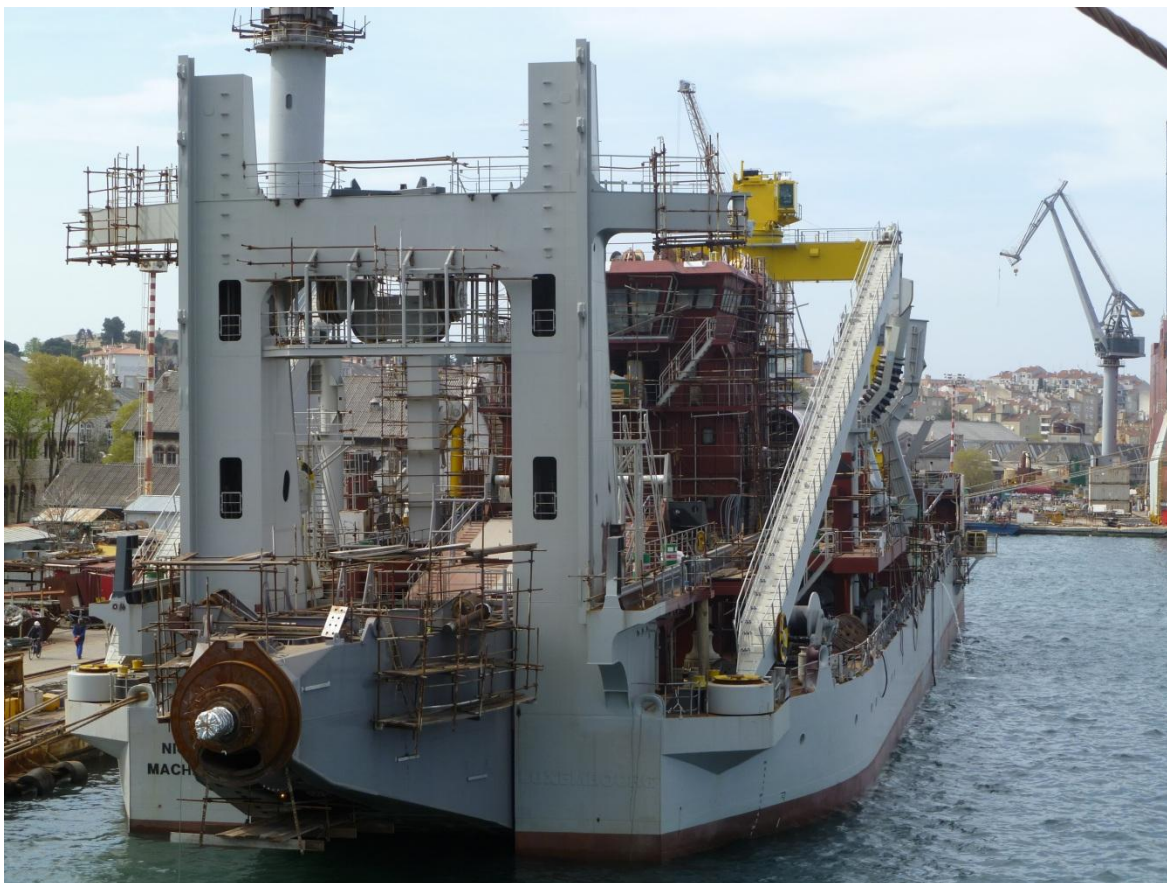
1.2. ábra: Kotróhajó szerelőpartfalnál az Uljanik hajógyárban (Pula, Horvátország)
