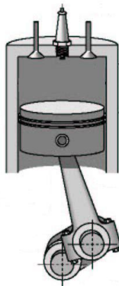
3.11. ábra: Közvetlen befecskendezésű égéstér vázlatja
