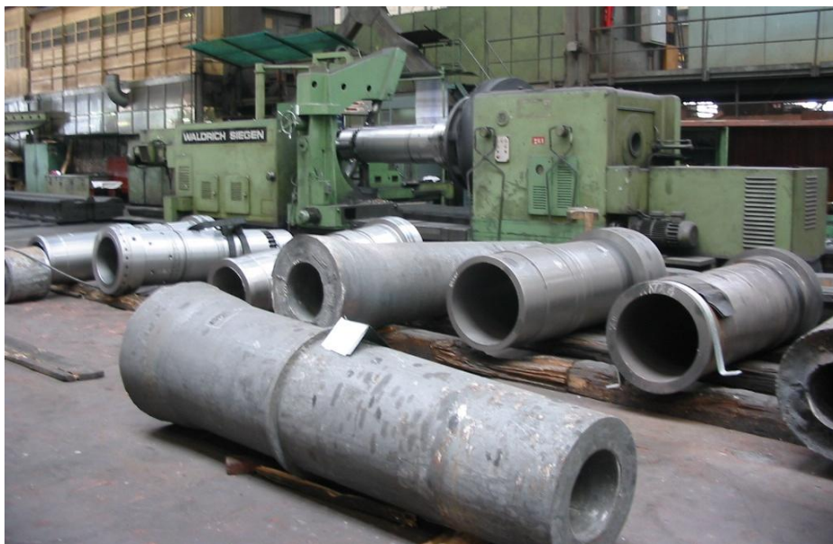
3.24. ábra: Különböző készültségi fokú hengerperselyek a rijekai Május 3 hajógyárban
