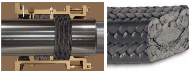
5.16. ábra: Tömszelence és betétje (balra), forrás: pacificmarine.net
