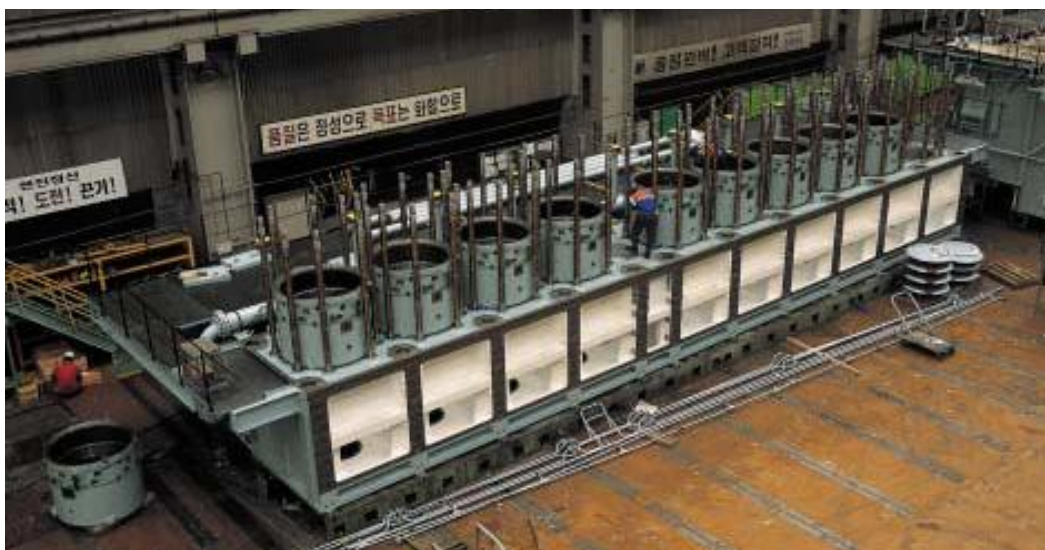
3.28. ábra: A Wärtsilä RT96C2 kétütemű, keresztfejes motor hengerperselye a hengertömbbe építve
