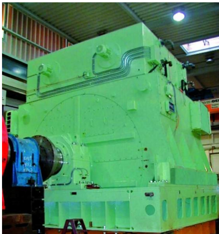
2.12. ábra: 21 MW-os szinkronmotor
