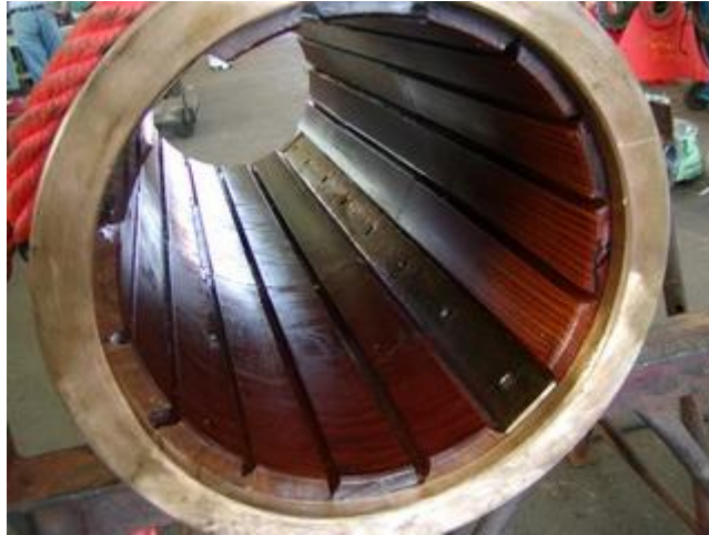
5.9. ábra: Pockfa csapágy felújítás után, forrás: www.cantierenoe.it
