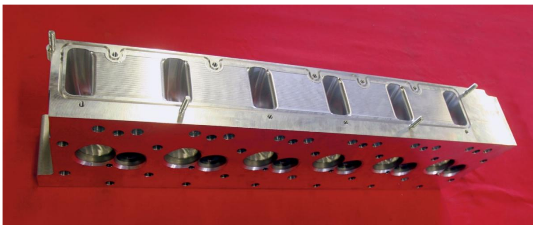
3.18. ábra: Négyütemű Cummins dízelmotor egybeöntött hengerfeje
