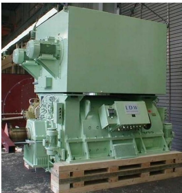
2.11. ábra: 950 kW-os egyenáramú motor
