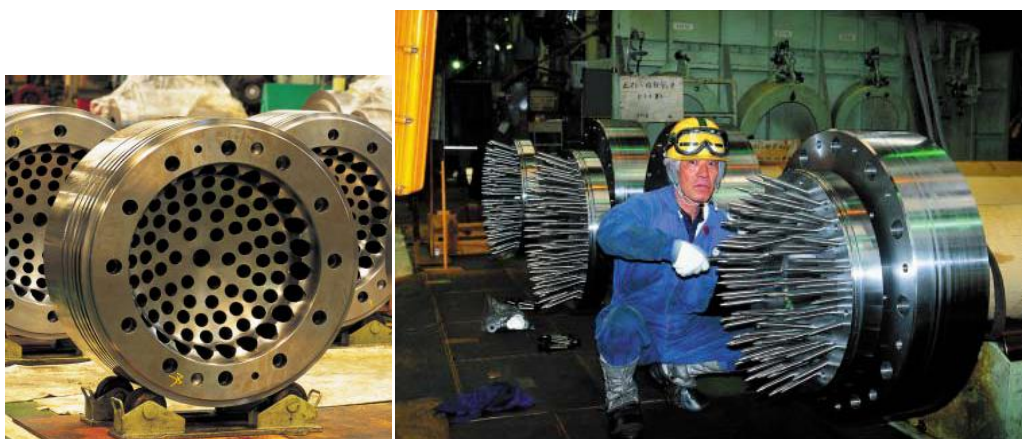
3.44. ábra: A Wärtsilä RT96C2 kétütemű, keresztfejes motor dugattyú felső és alsó része
