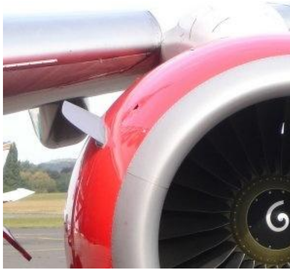
179. ábra: Terelőlemez a szárny és a hajtómű-gondola közötti interferencia ellenállás csökkentésére
