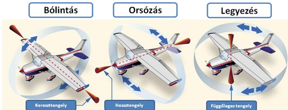
207. ábra Repülőgép tengelyei és térbeli mozgásai
