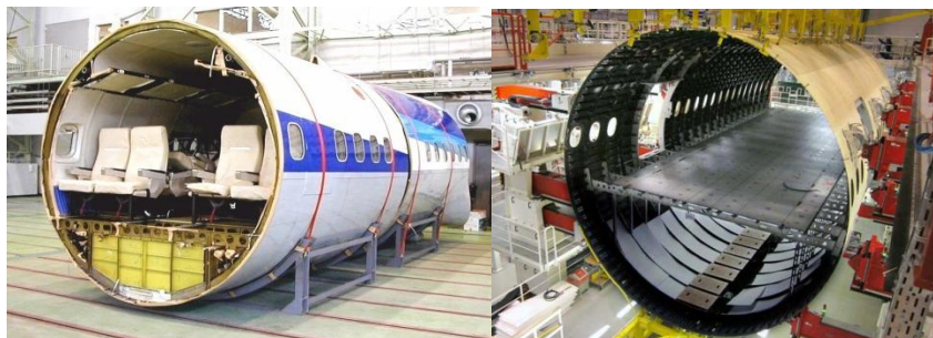
206. ábra Utasszállító repülőgép törzsének elrendezése és belső szerkezete
