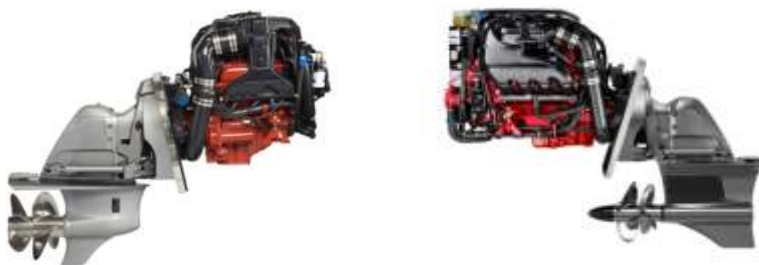
1.1.5. ábra: Balra a Mercury tolópropelleres, jobbra pedig a Volvo húzópropelleres Z hajtóműve
