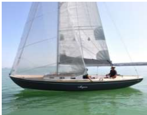
2.1.19. ábra: Balra egy orrvitorla, jobbra egy nagy átfedésű génua – jól látszik, hogy a vitorla alsó sarka az árboc mögé nyúlik
