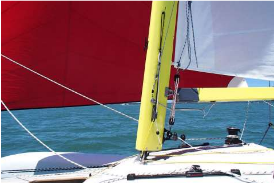
2.3.18. ábra: Forgatható szárnyprofil keresztmetszetű árboc egy katamaránon (jól látható a gömbcsukló, amin áll)
