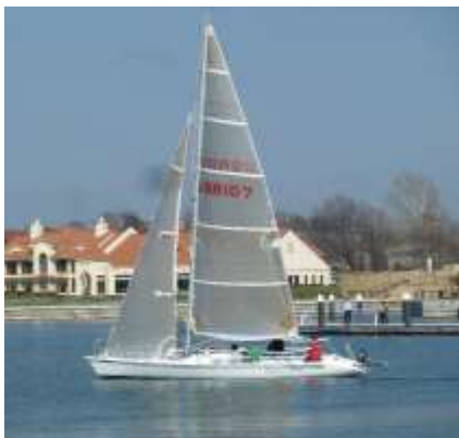
2.1.19. ábra: Balra egy orrvitorla, jobbra egy nagy átfedésű génua – jól látszik, hogy a vitorla alsó sarka az árboc mögé nyúlik
