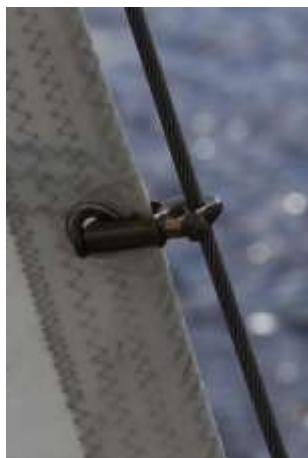
2.1.20. ábra: Orrvitorla stagreiterrel rögzítve felhúzott (balra) és leengedett állapotban (jobbra)
