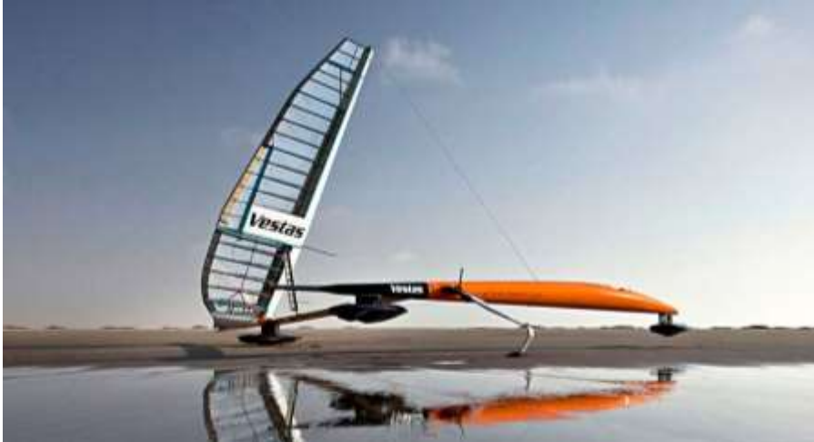
2.1.30. ábra: Egy vitorlás sebességi rekordot elérő szárnyas vitorlás merev vitorlával
