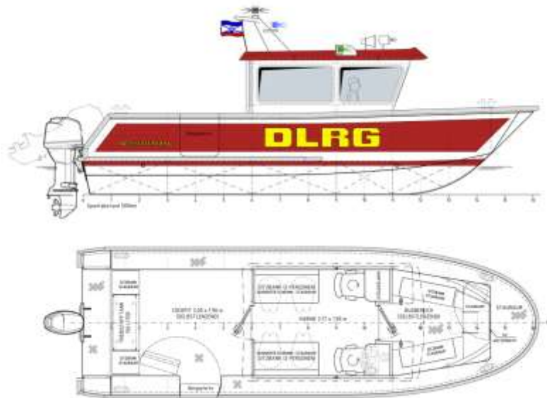
1.1.8. ábra: 8 m-es mentőhajó külmotorral felszerelve
