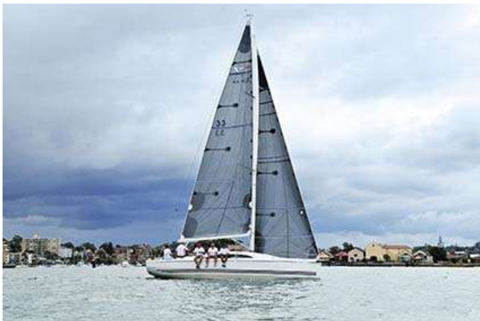
2.1.16. ábra: Az igazi klasszikus bermuda vitorlázat
