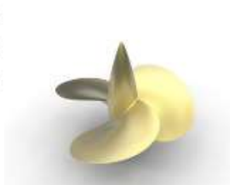
1.2.4. ábra: KCA hajócsavar vázlata és modellje
