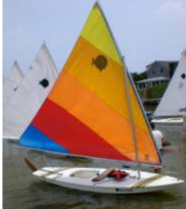
2.1.3. ábra: Sunfish típusú kishajó latin vitorlával
