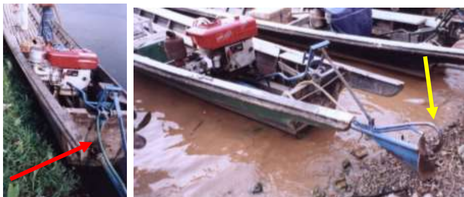
1.1.22. ábra: Burmai „long-tail” hajtásrendszer
