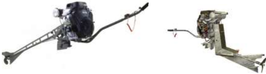
1.1.20. ábra: Modern seprűsmotorok
