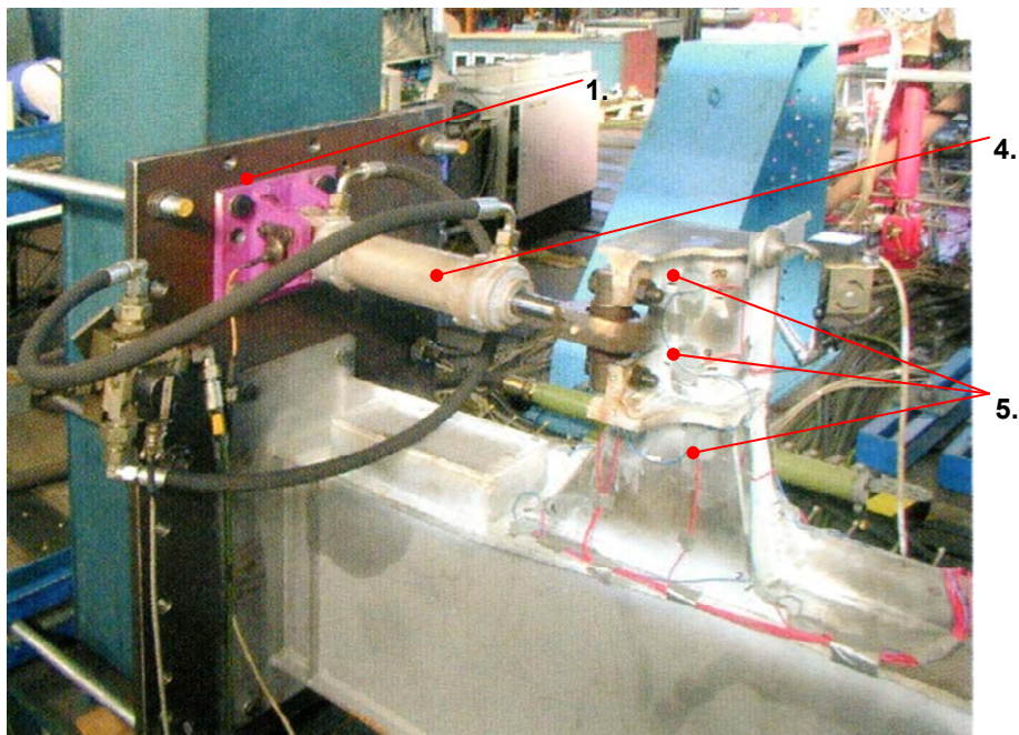
7.25. ábra. Vasúti forgóvázkeret fárasztó-vizsgálata - 2
