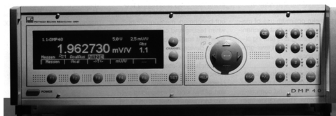
1.25. ábra. DMP 4.0 típusú mérőerősítő
